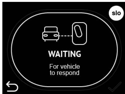
Abbildung 16: Die Ladestation wartet auf die Antwort des Elektrofahrzeugs und beginnt mit dem Laden
