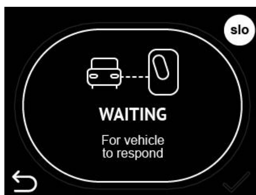
Figur 15: Laddningsstationen väntar på att fordonet ska svara och börjar ladda
