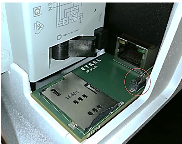
Figura 42: Botão de reinicialização dentro da abertura de manutenção
