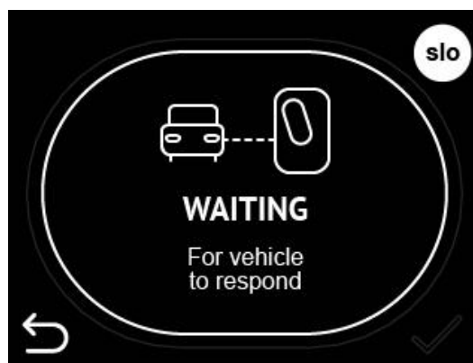
Rysunek 15: Stacja ładowania czeka na zgłoszenie się pojazdu elektrycznego i rozpoczyna ładowanie
