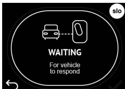
Figure 15: La station de charge attend que le véhicule électrique réponde pour commencer à charger
