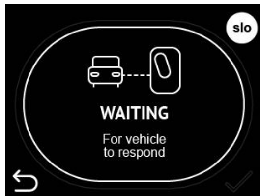
Figura 15: La estación de carga está esperando que el VE responda y comience a cargar
