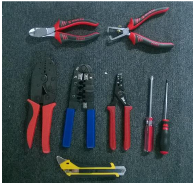
Figur 43: Utrustning som används för installation av laddningsstationen
