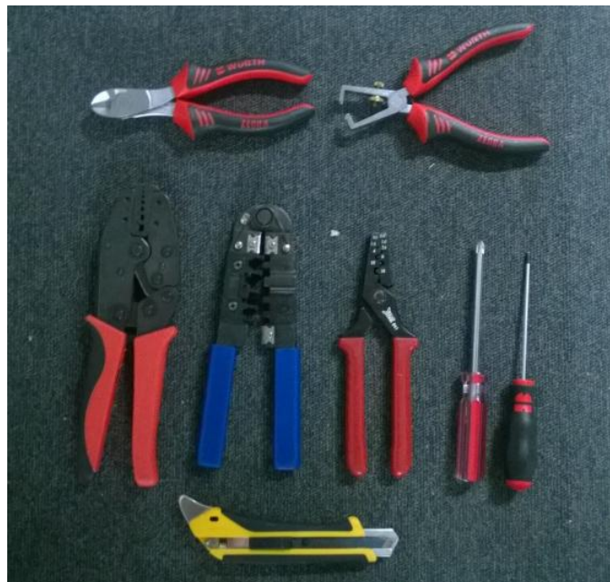
Figur 43: Udstyr, der anvendes til montering af ladestationen
